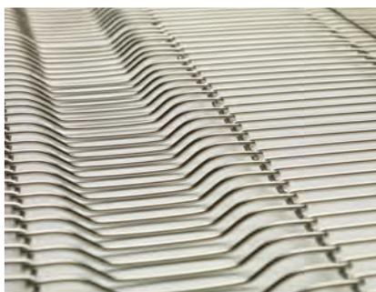
**Ausrichtungsbänder** helfen beim Fördern von Produkten, die Hintereinander in Reihe bleiben müssen. Dabei helfen Nocken, deren Position über die Gurtlänge gleich bleibt. Diese bilden dann eine Art Mulde, welche das Produkt in Position hält. Die Anzahl der Reihen und die Abstände sind variabel.
