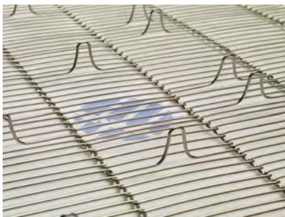
**Spitznocken** können genutzt werden, um das Produkt zu tragen und so den Kontakt von Produkt und Fördergurt auf ein Minimum zu reduzieren.
